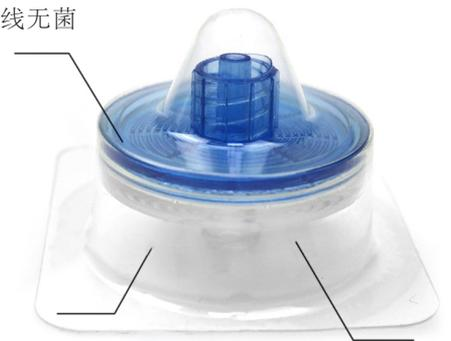
打印标识的区域用以明确膜材及过滤精度 每个过滤器单独包装
